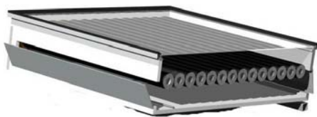
Figure 2 : Vue du capteur-adsorbeur à tubes
