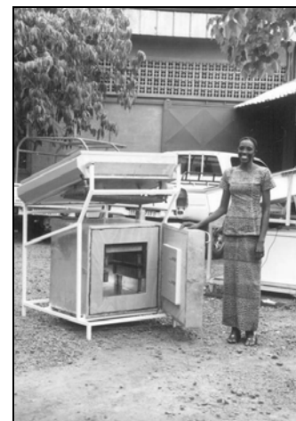
Figure 5 : Prototype "made in Burkina", système avec capteur-adsorbent à tubes, silicagel-eau, 1 m 2 de capteur solaire et 80 litres de volume réfrigéré
