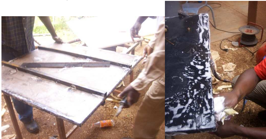
Figure 2: Nouvel absorbeur (gauche), test d'étanchéité (droite)
