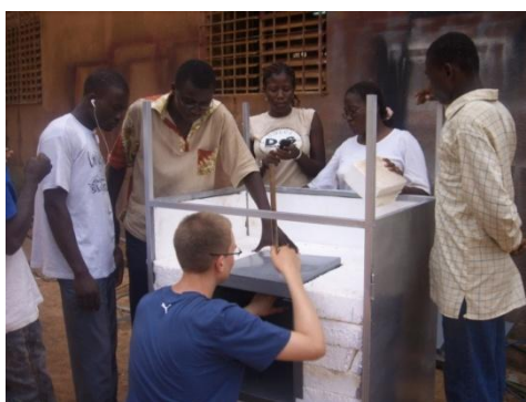
Figure 4: Mise à niveau de l'évaporateur
