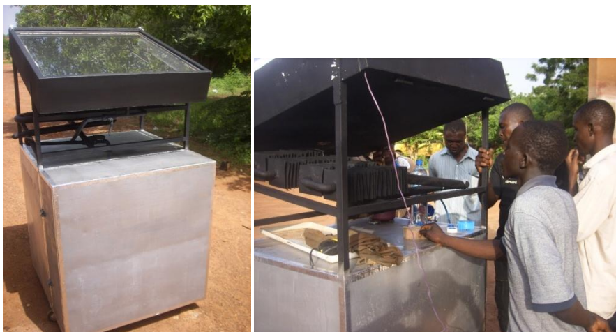
Figure 12: Frigo fini (gauche), frigo avec baromètre en train d'être testé (droite)
