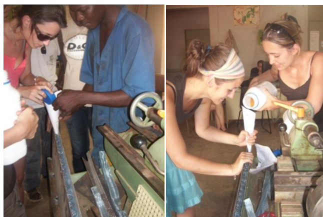
Figure 6: Remplissage de l'absorbeur par le silicagel
