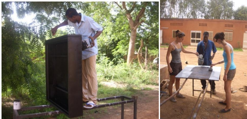
Figure 8: Peinte du capteur et de l'absorbeur
