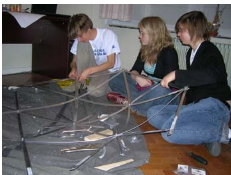
Figure 29 : Assemblage des lattes pour former la structure du miroir
