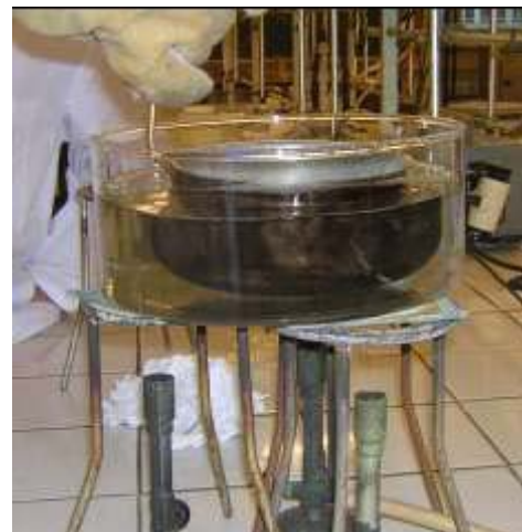
Figure 22 : Rapidement le cuivre de la casserole devient noir
