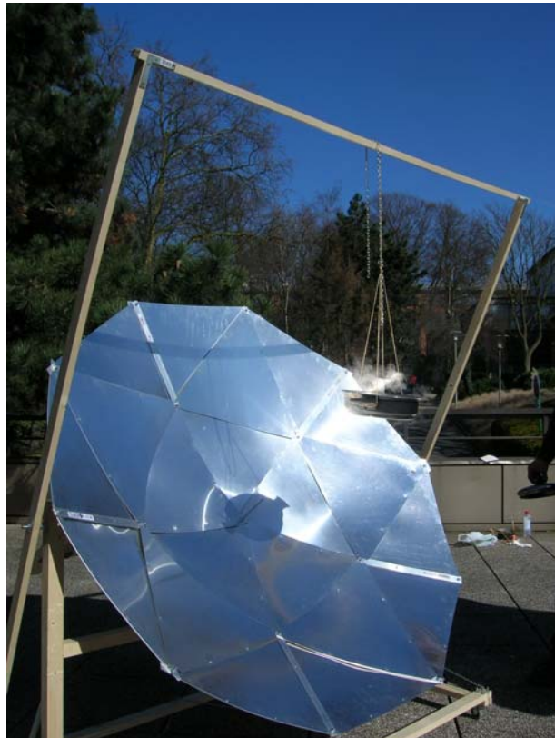
Figure 37 : Chauffage de 50 cl d'eau grâce à l'énergie solaire
