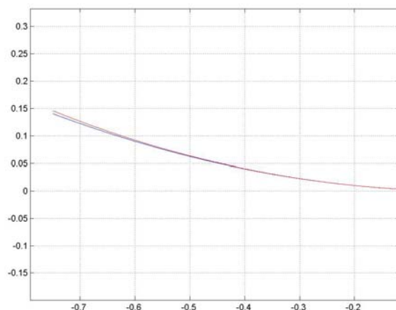
Figure 16 : Approximation d'un paraboloïde (en bleu) (diamètre et distance focale égales à 1,5 m) par une calotte hémisphérique (en rouge). L'échelle des axes est en mètre
